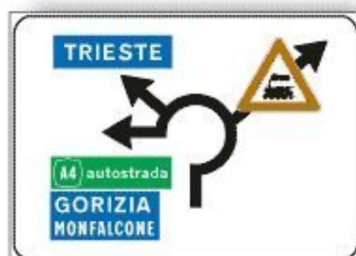
F.239 PREAVVISO DI INTERSEZIONE URBANA ROTATORIA CON SEGNALE DI DIVIETO SU UN RAMO
