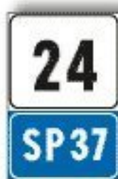
F.267 PROGRESSIVA DISTANZIOMETRICA STRADA PROVINCIALE
