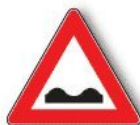
F.1 STRADA DEFORMATA
